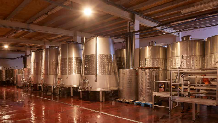
Tanques troncocónicos y cónicos de acero inoxidable donde fermenta el mosto.
